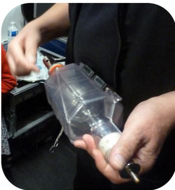
Voici l'ampoule qui est dans l'énorme machine. C'est grâce à elle que nous voyons les films. Elle chauffe tellement qu'elle est enfermée dans une protection en plastique pour ne pas abîmer l'intérieur du projecteur en cas d'implosion.
